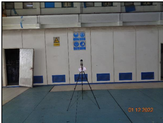
ภาพที่ 3.35 การตรวจวัดระดับเสียงบริเวณเครื่องจักร บริเวณอาคาร Turbine Generator ชั้น 3 ภายในห้องเก็บเสียง (กักหนัสน้ำ)
